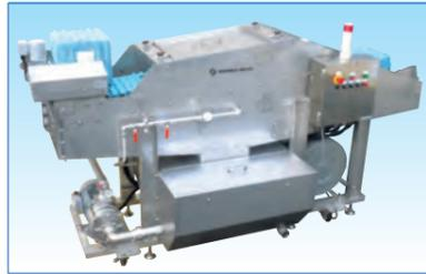
工程 ▶ 自動供給 ▶ 洗浄 ▶ すすぎ ▶ 水切 ▶ 整列積重 ▶ 搬出
